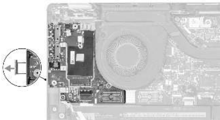
Abbildung 1. Entfernung der I/O-Zusatzplatine
