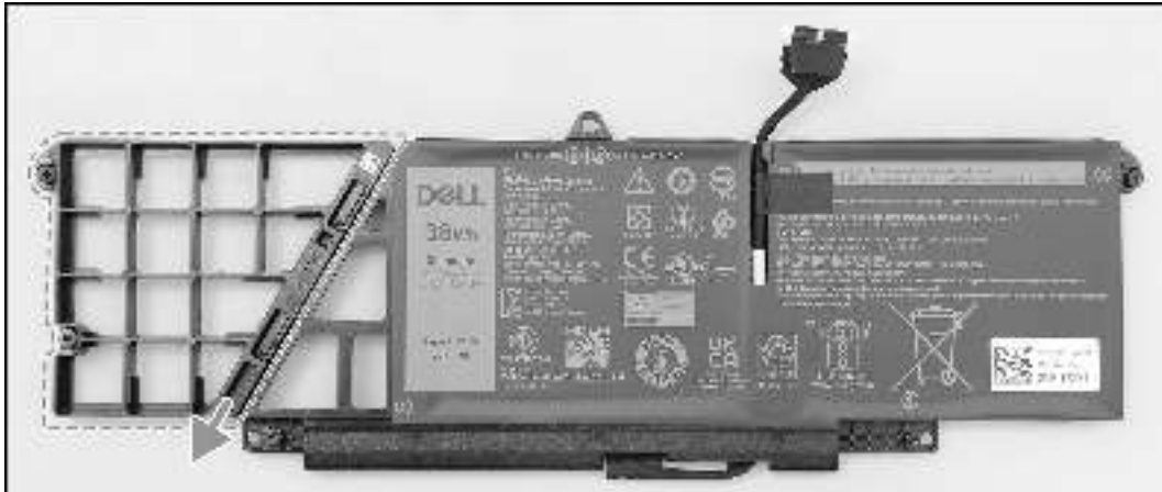
Abbildung 5. Entfernen des 2-Zellen-Akkus
