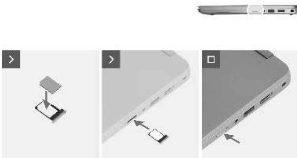
Abbildung 3. Abbildung: Installieren des SIM-Kartenfachs
