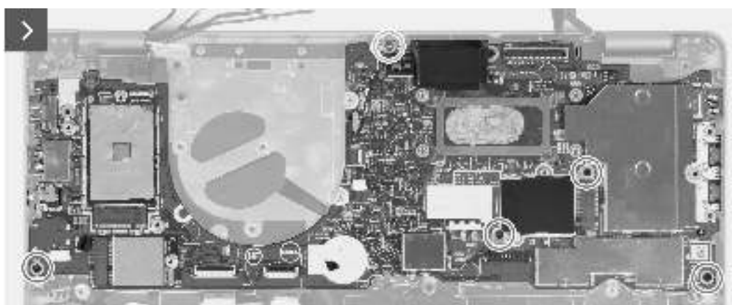
Abbildung 6. Entfernen der Hauptplatine
