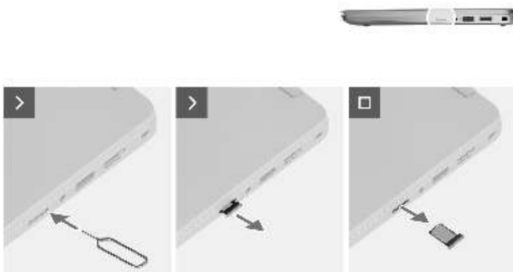
Abbildung 2. Entfernen des SIM-Kartenfachs
