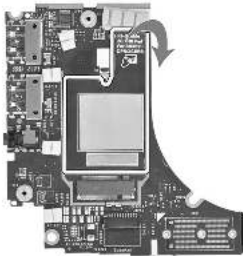
Abbildung 71. Latitude 7450 in der 5G-WWAN-Konfiguration (Wärmeleitpad-Aufkleber)
