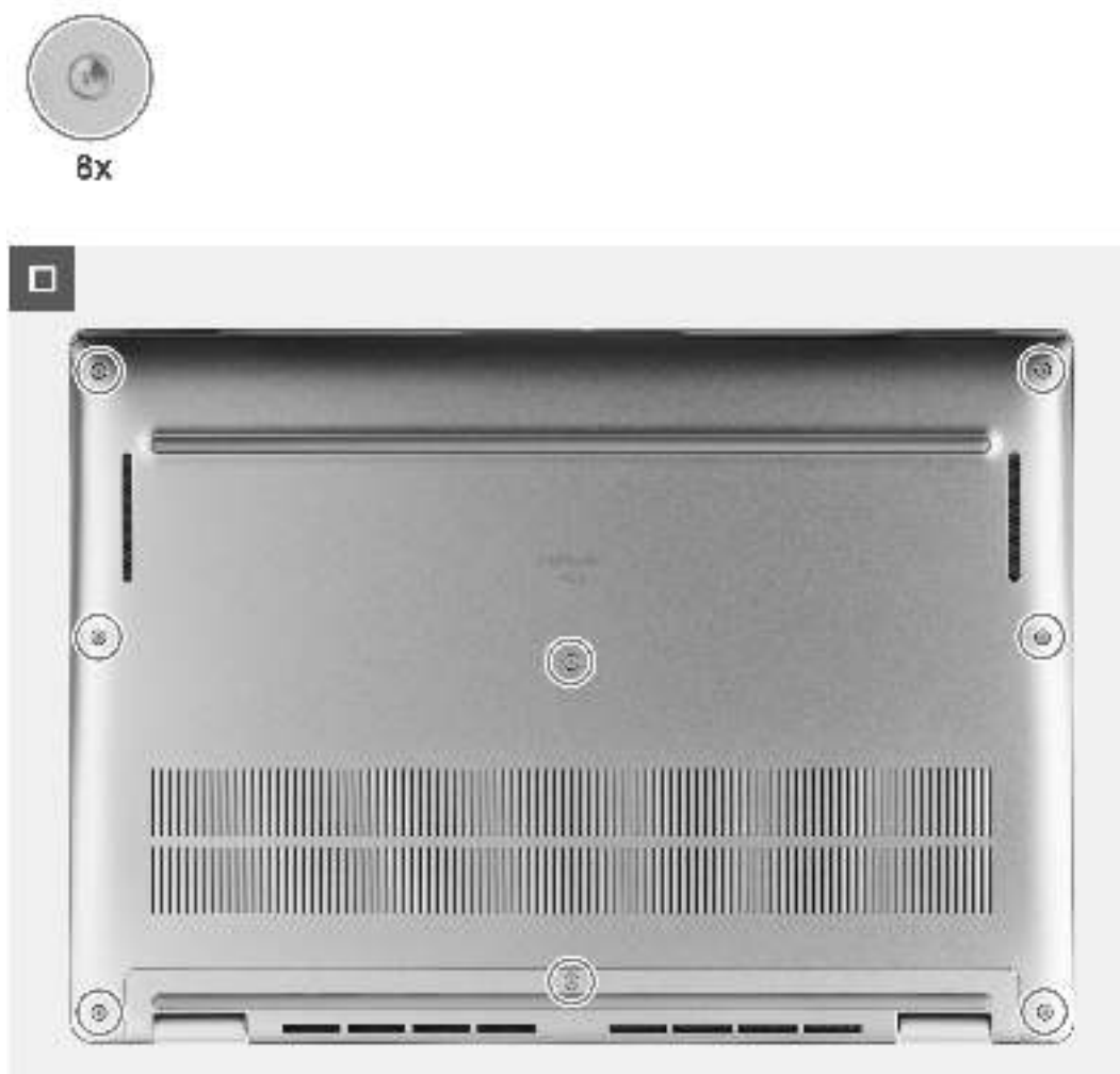
Abbildung 18. Installieren der Bodenabdeckung
