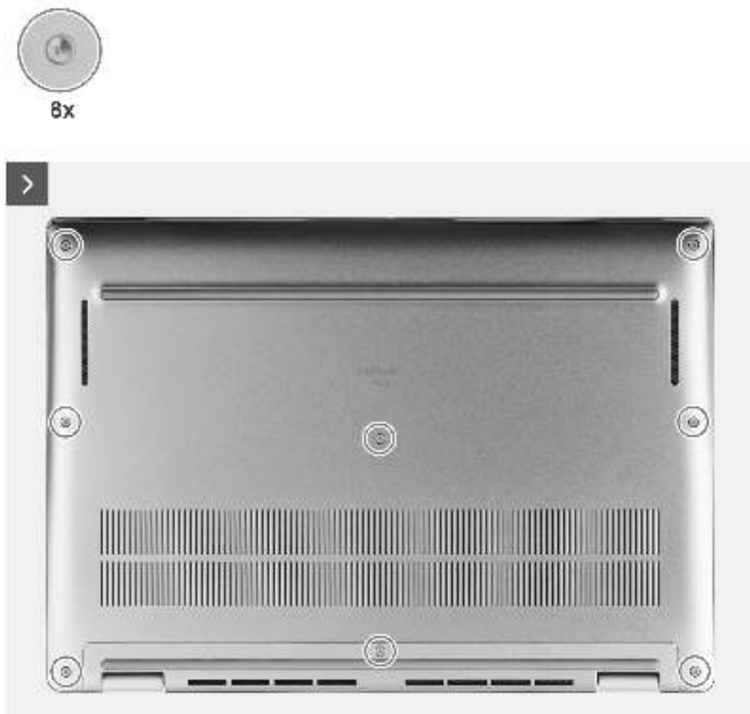
Abbildung 15. Entfernen der Bodenabdeckung
