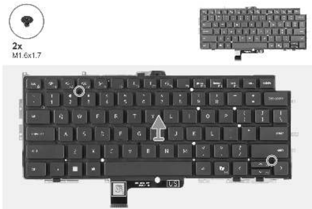
Abbildung 76. Entfernen der Tastatur
