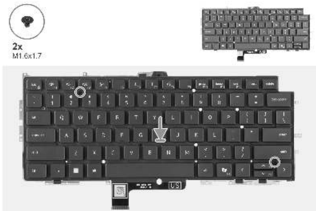
Abbildung 79. Installieren der Tastatur
