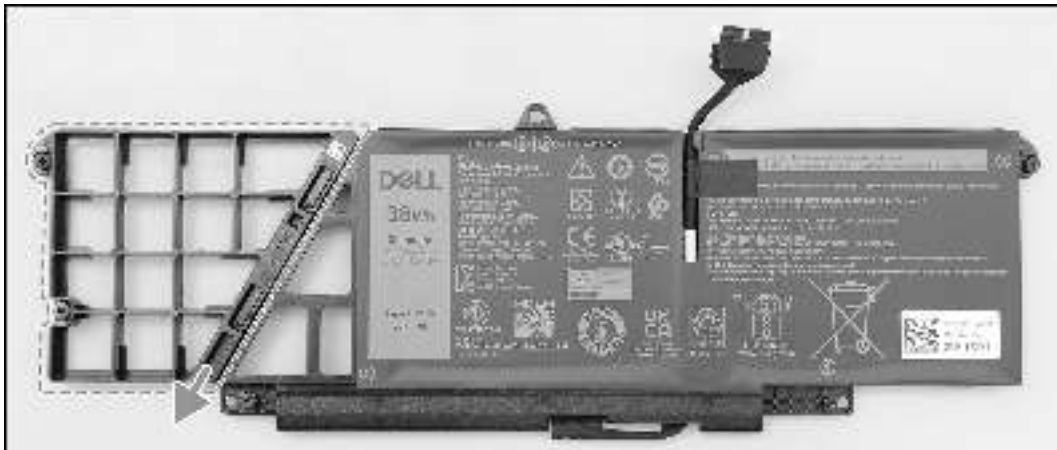
Abbildung 35. Entfernen des 2-Zellen-Akkus
