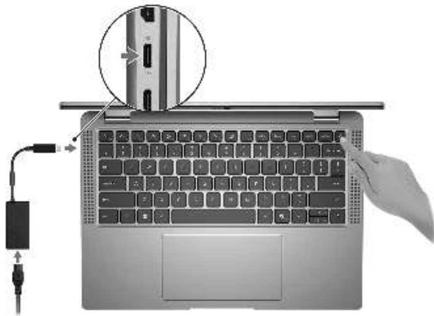
Abbildung 11. Anschließen des Netzteils und Drücken des Netzschalters
