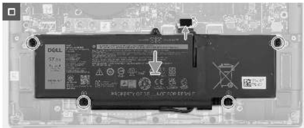
Abbildung 40. Installieren des 3-Zellen-Akkus
