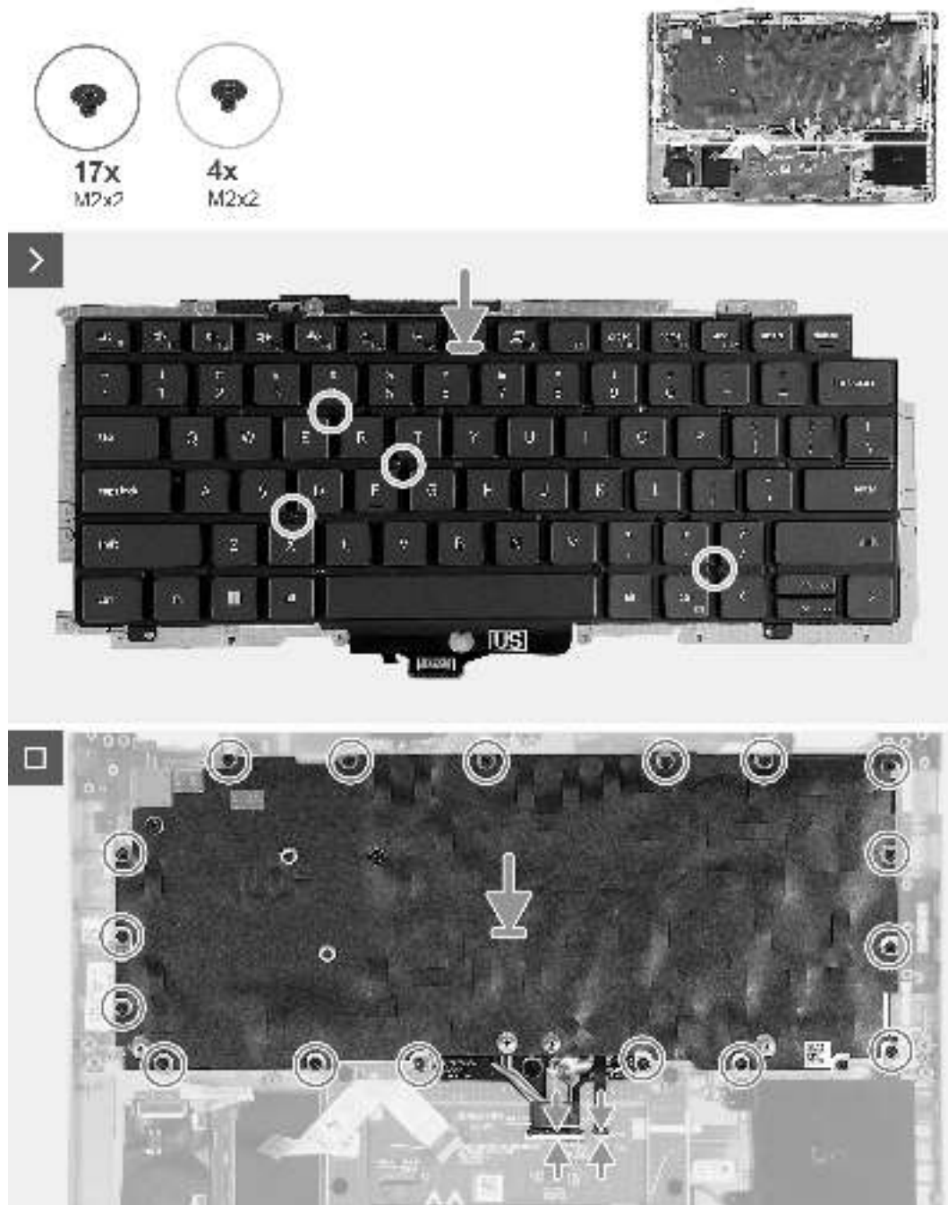
Abbildung 66. Einbauen der Tastatur
