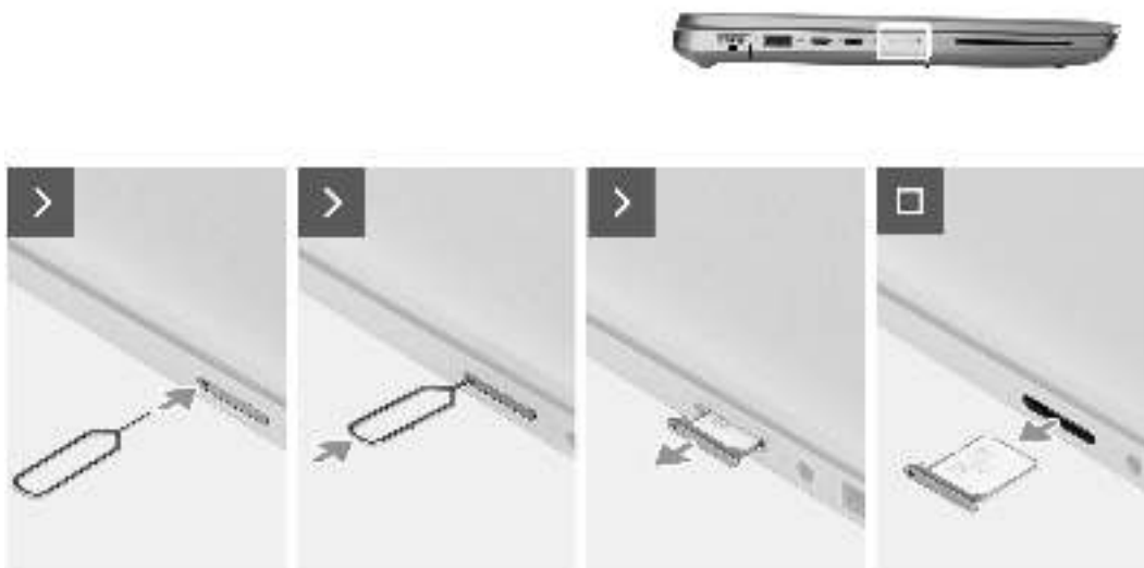
Abbildung 2. Entfernen des SIM-Kartenfachs
