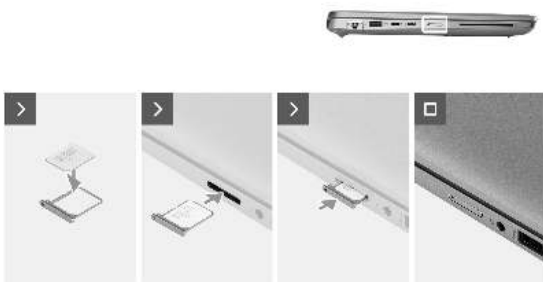
Abbildung 3. Installieren des SIM-Kartenfachs
