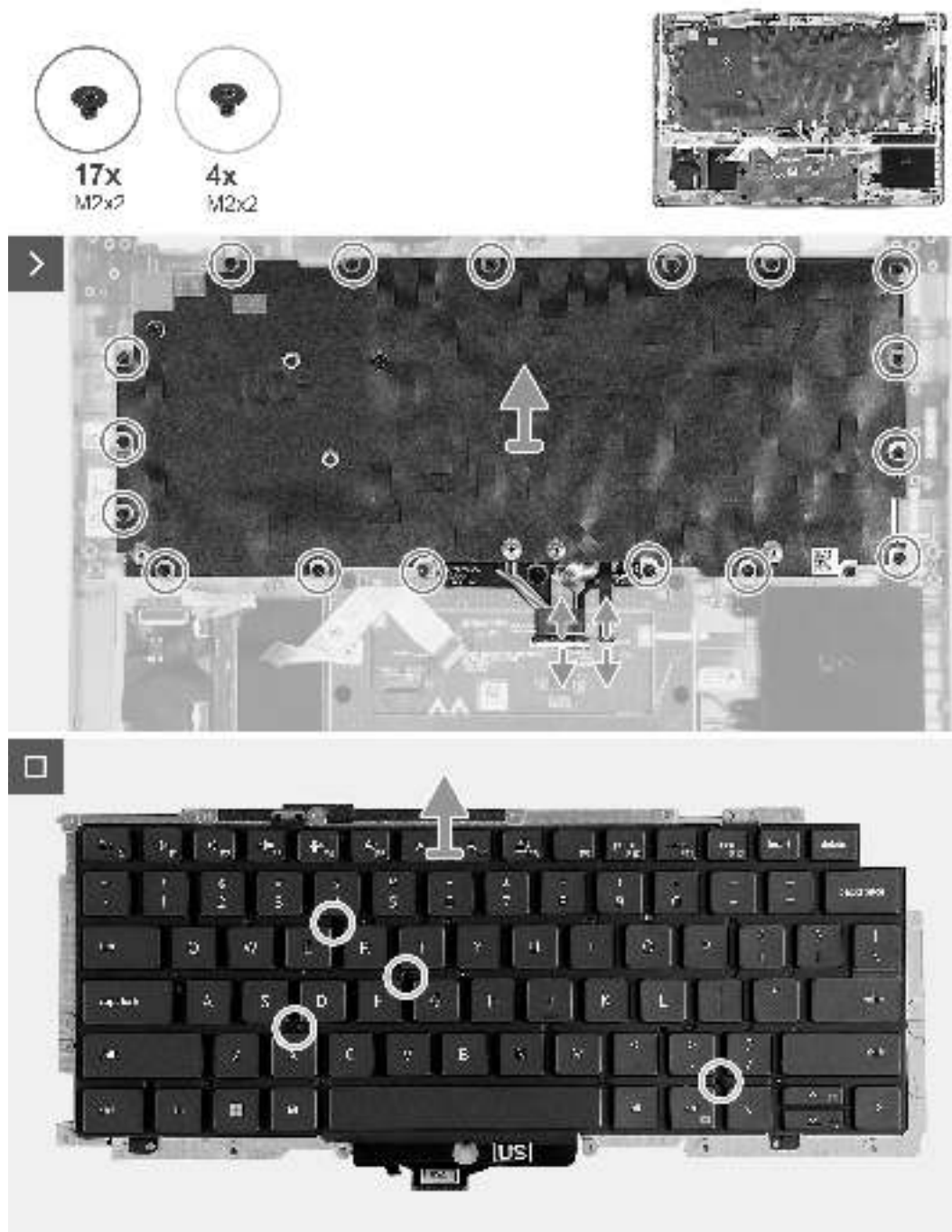
Abbildung 65. Entfernen der Tastatur
