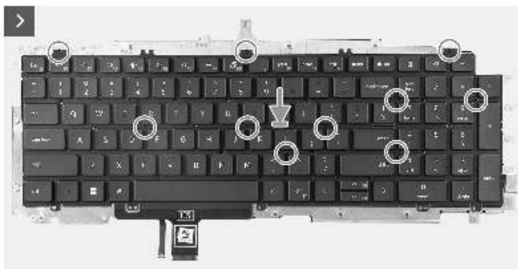
Abbildung 67. Installieren der Tastatur
