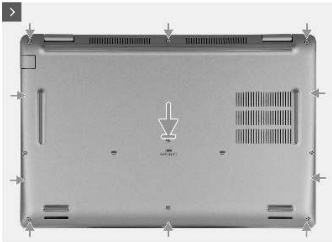
Abbildung 17. Installieren der Bodenabdeckung
