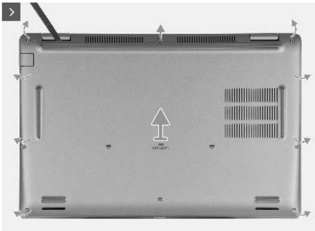
Abbildung 14. Entfernen der Bodenabdeckung
