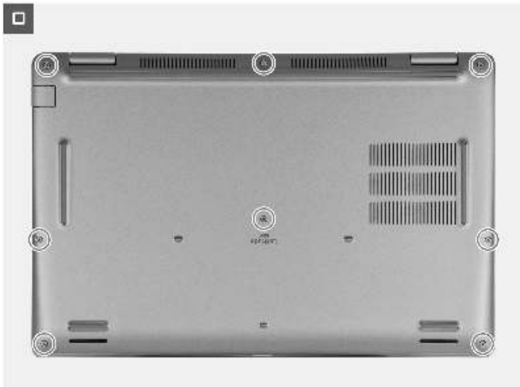
Abbildung 18. Festziehen der unverlierbaren Schrauben
