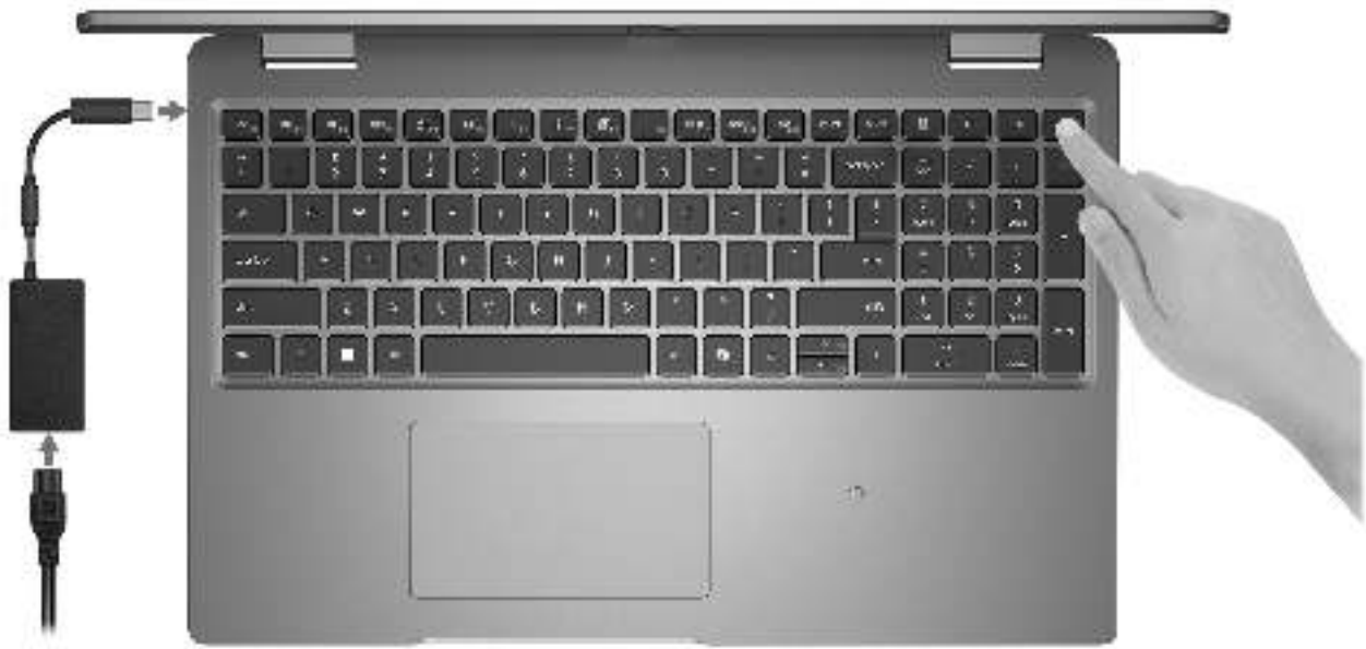
Abbildung 8. Anschließen des Netzteils und Drücken des Netzschalters
