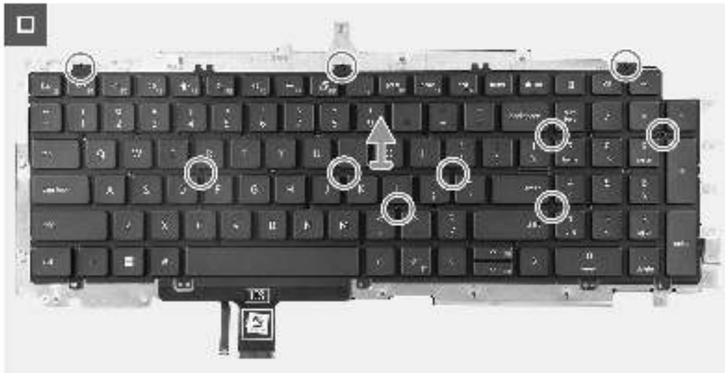
Abbildung 66. Entfernen der Tastatur
