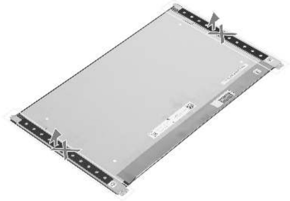
Abbildung 79. Lösen Sie nicht die SR-Bänder (Stretch Release).
