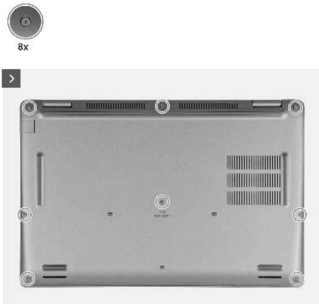
Abbildung 13. Lösen der unverlierbaren Schrauben
